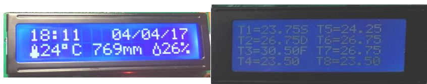
Рисунок 1 Пример: вывод данных на LCD дисплей с одной и группы 8-ми термопар
