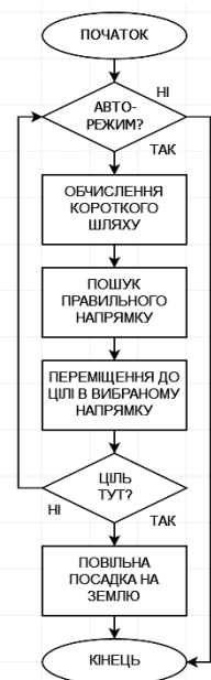
Рис. 5. Алгоритм автоматичного повернення БПЛА до стартової точки
