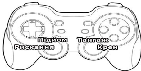
Рис. 3. Схема функцій джойстика
