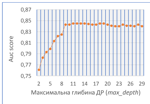
Рис.3. Залежність точності класифікації від максимальної глибини дерева рішень
