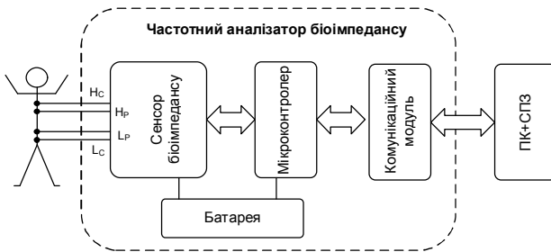
Рис. 2. Архітектура портативного частотного аналізатора біоімпедансу
