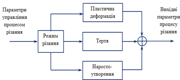
Рис. 2. Схема процесу різання у вигляді системи дисипативних процесів ( Fig. 2. Scheme of the cutting process in the form of a system of dissipative processes)
