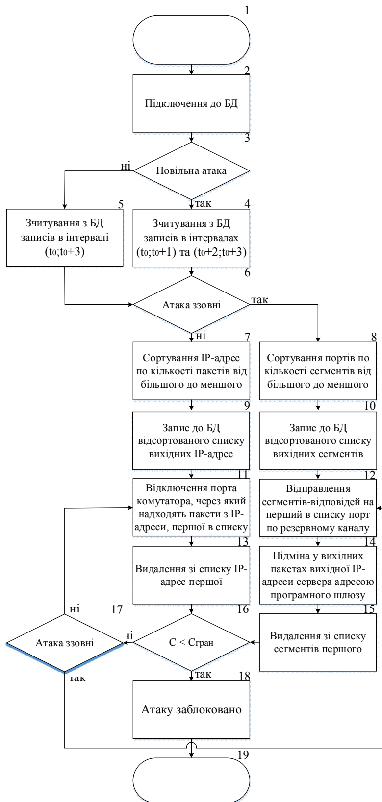
Рис. 5. Схема алгоритму блокування DDoS-атак
