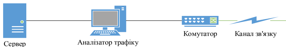
Рис. 2. Розміщення аналізатору трафіку в інформаційній мережі
