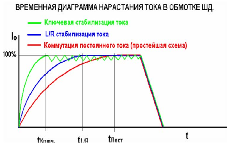
Рис. 1 - Поведение системы для резистивной и импульсной форсировок.
