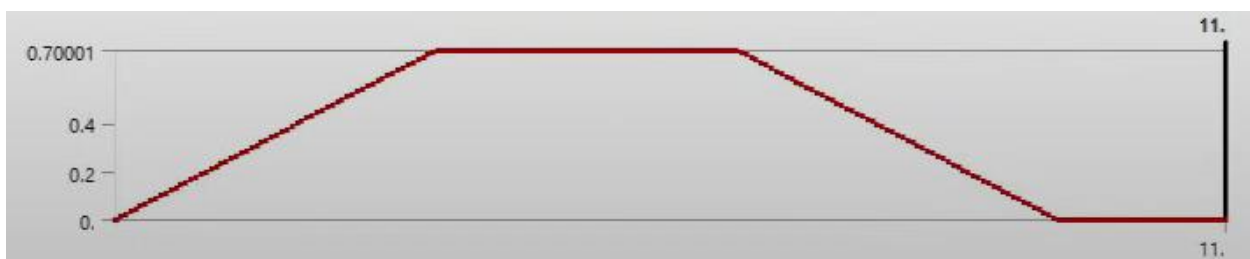
Рис. 16 – Графічна залежність зміни швидкості баштового крана у програмному середовищі Ansys Mechanical
