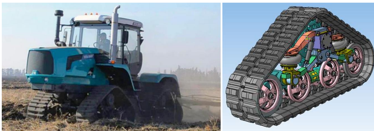
Рис. 2 – Трактор ХТЗ-280Т зі змінними ходовими системами та варіант змінного гусеничного рушія
