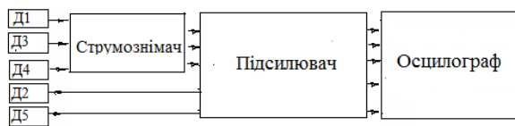
Рис. 2. Схема для вимірювання ПТ у гідротурбіні РО115
