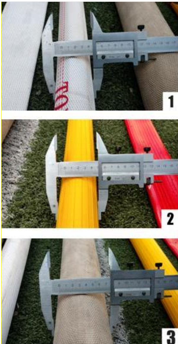
Рис. 2. Визначення геометричних параметрів досліджуваних пожежних рукавів (зміна діаметра):
