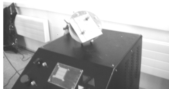
Рис. 4 – Загальний вигляд інструменту МІОМ з можливим підключенням попереднього індукційного нагрівання листового об'єкта обробки
