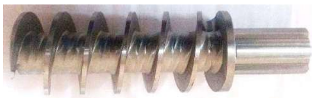
Рис. 9 – Фото виготовленого шпильового шнека методом механічної обробки
