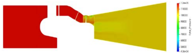
Рис. 11. Розподіл повного тиску в меридіональному перетині капсульної гідротурбіни
