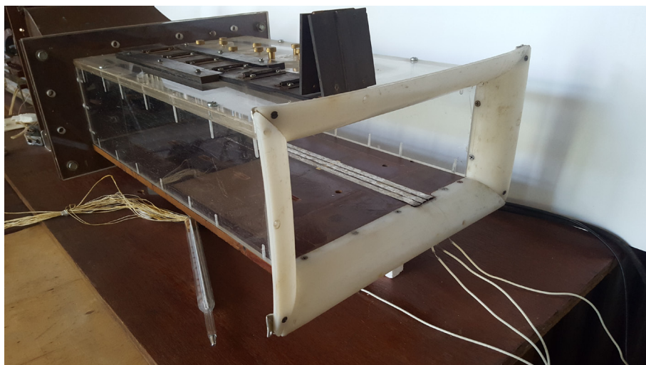
Рис. 1 – Низькошвидкісна малогабаритна аеродинамічна труба
