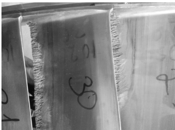
Рис. 1 – Эрозионный износ входных кромок рабочих лопаток
