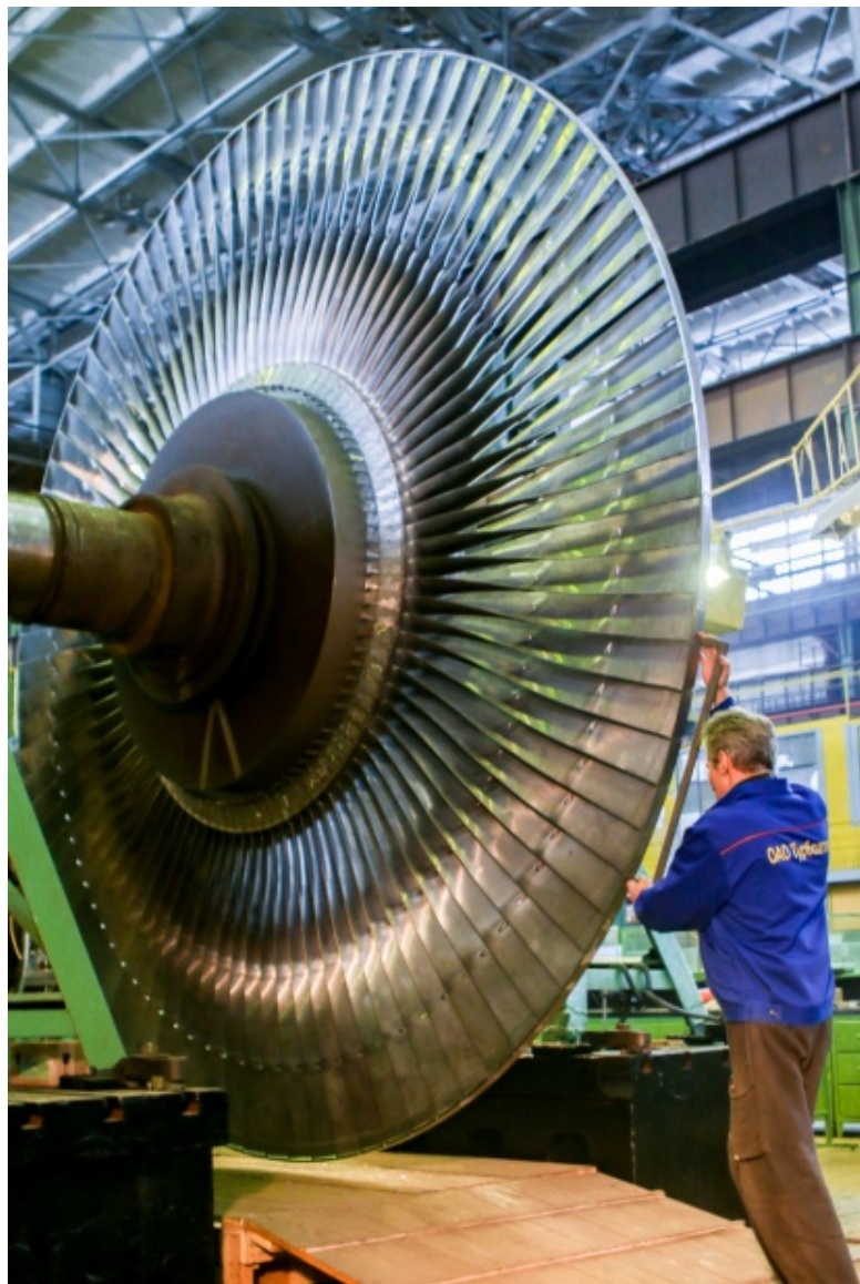
Рис. 12 – Контрольная сборка на технологическом диске
