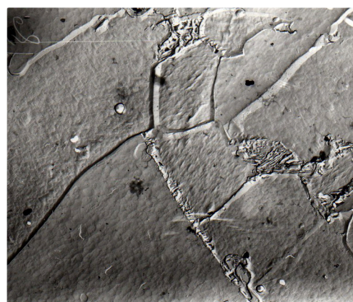
Рис. 2 – Электронно-микроскопический снимок структуры наплавленного металла, содержащего 0,009 % РЗМ (x15000)
