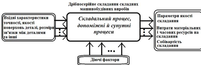
Рис. 1 – Інформаційна схема технологічної операції складання виробу
