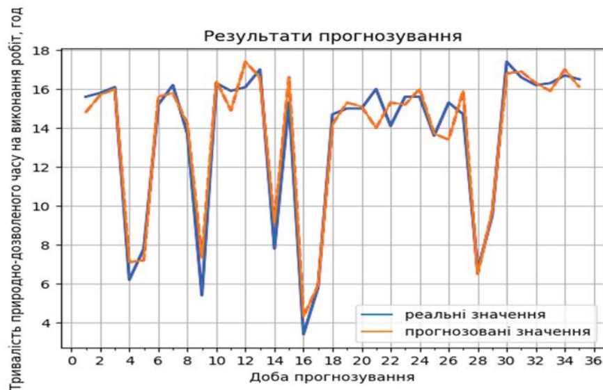
Рис. 8. Результати планування тенденцій зміни природно-дозволеного часу виконання робіт впродовж окремих діб життєвого циклу гібридних проєктів
