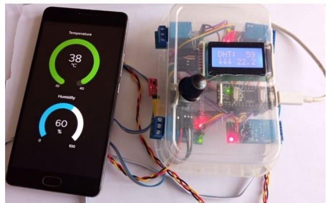
Рис. 8. Тестування системи за допомогою мобільного додатку
