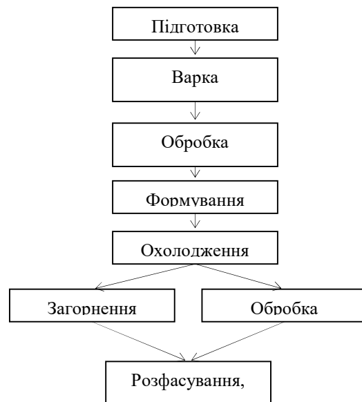
Рис. 1. Функціональна схема виробництва карамелі
