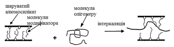
Рис. 4. Схема процесу інтеркаляції гідрофобних молекул олігомерів у міжшарові галереї органомодифікованого шаруватого алюмосилікату
