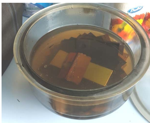
Рис. 3 – Дослід для визначення водопоглинання
