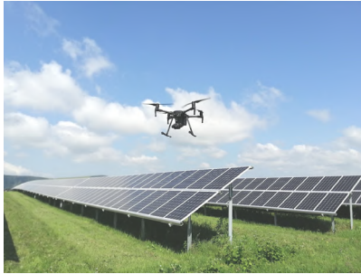
Рис. 2 – Контроль стану сонячних модулів за допомогою БПЛА
