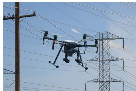
Рис. 1 – Перевірка інфраструктури електропостачання за допомогою БПЛА
