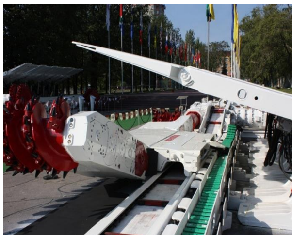
Рис. 1 - Комбайн очисний УКД200-500
