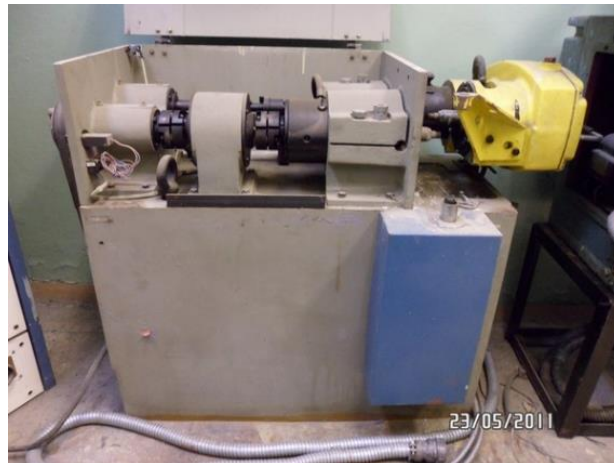
Рис. 2 – Спеціальна машина тертя СМТ-1С випробування циліндричних зубчастих коліс з асиметричним профілем
