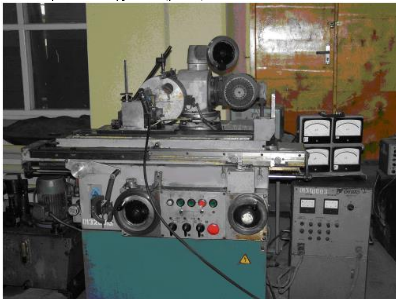
Рис. 1 – Модернізований універсально-заточний верстат мод. ЗД642Е
