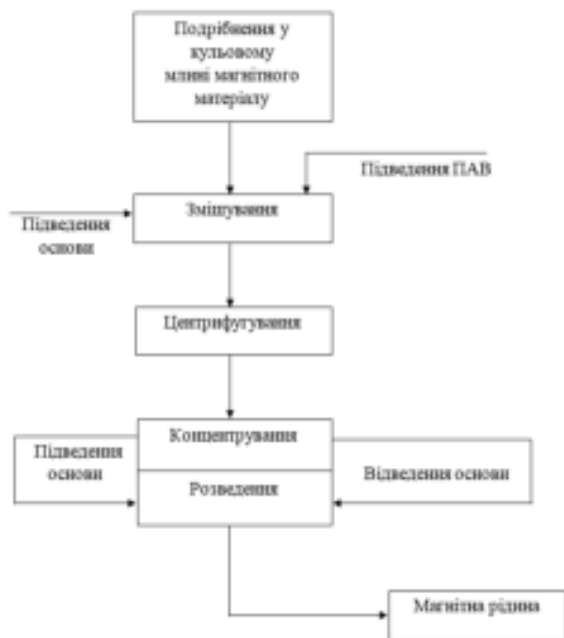
Рисунок 1 – Алгоритм виготовлення магнітної рідини
