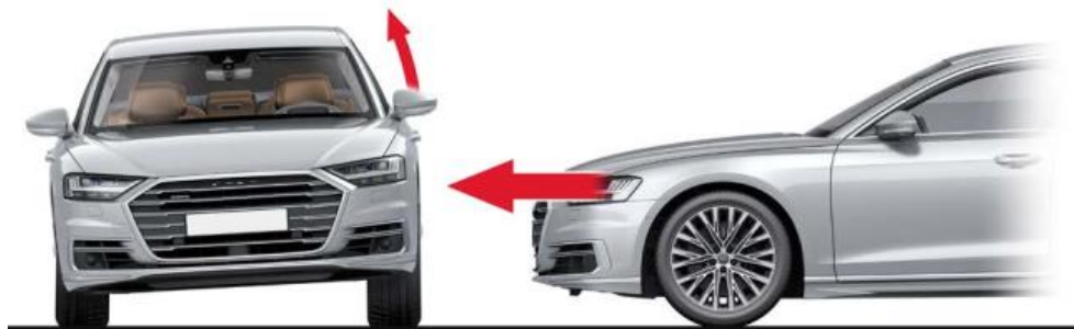
Рис. 5 – Бокове зіткнення з функцією краш-підйому
