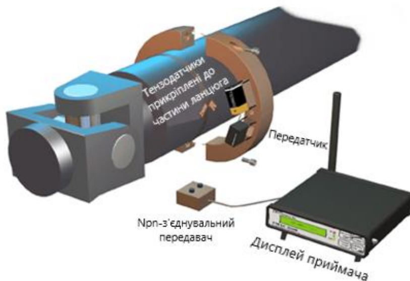
Рис. 6 – Взаємодія датчиків і FM зв'язку
