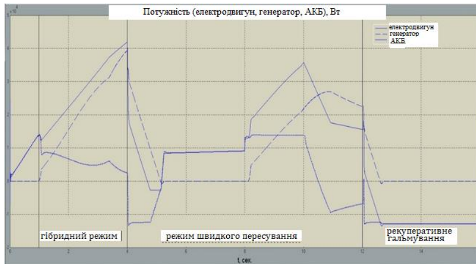
Рис. 10 – Зміна потужності електродвигуна, генератора і АКБ в процесі руху
