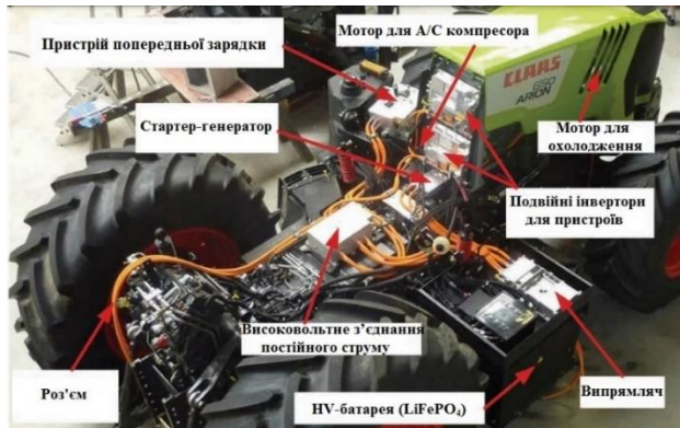
Рис. 8 – Високовольтна система в CLAAS Arion 650 Hybrid
