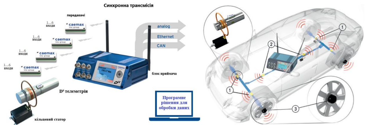
Рис. 7 – Використання тензометричних датчиків в автомобілебудуванні
