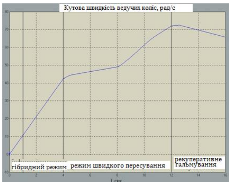
Рис. 14 – Зміна кутової швидкості повідних коліс
