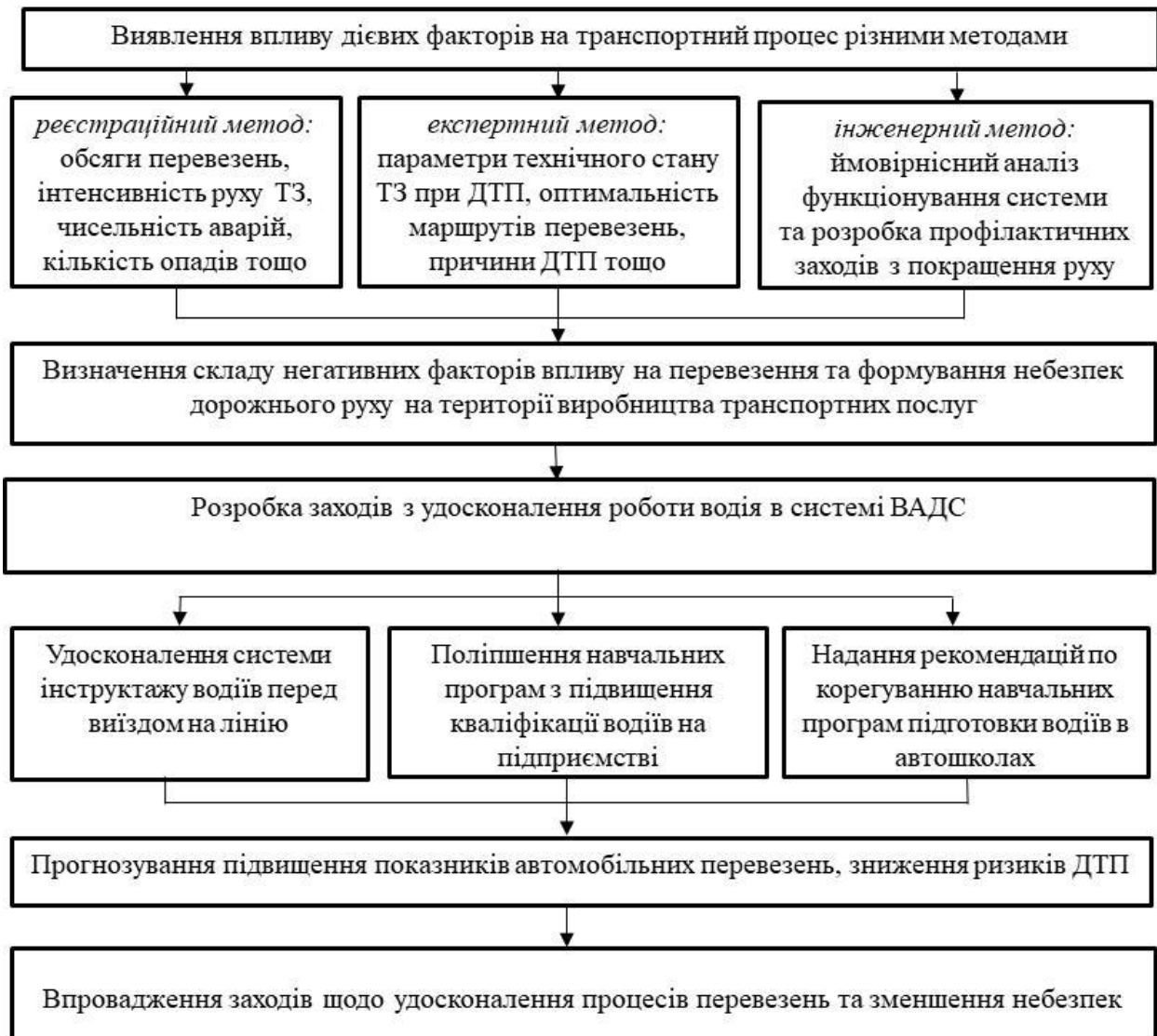
Рис. 2. – Схема алгоритму щодо визначення впливу факторів системи ВАДС та водія на ефективність транспортного процесу
