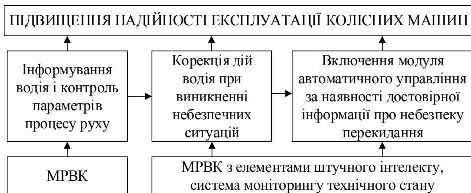
Рис. 1. – Структурна схема забезпечення надійності експлуатації колісної машини
