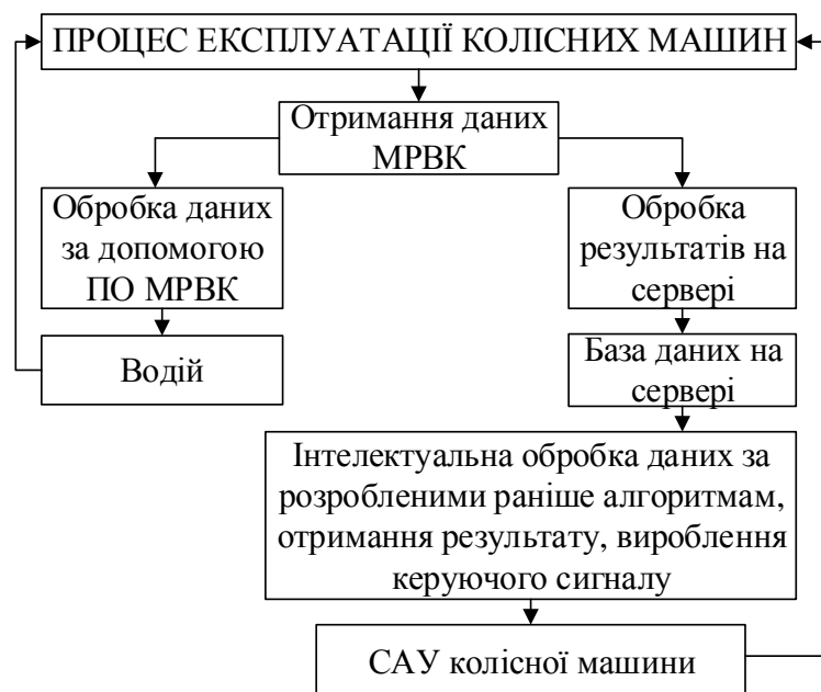
Рис. 4. – Схема функціонування реєстраційно-вимірювального комплексу з елементами штучного інтелекту
