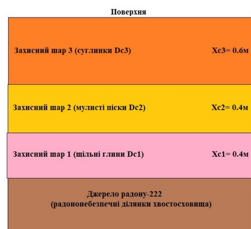
Рис. 4 Структура тришарового протирадонового покриття радононебезпечних ділянок II секції Сухачівського хвостосховища
