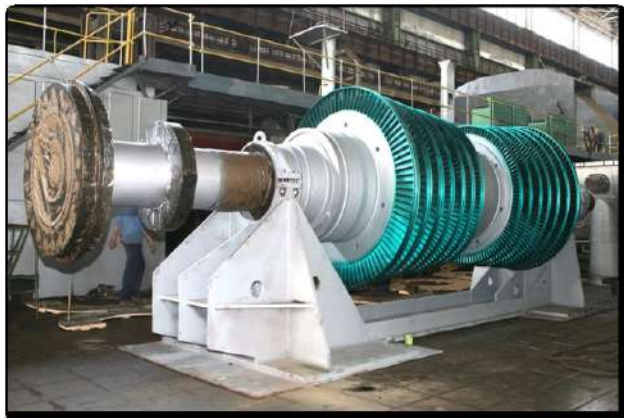
Рис. 3 – Модернізований ротор високого тиску турбіни К-1000-60/1500-2 бл. 4 Балаковської АЕС
