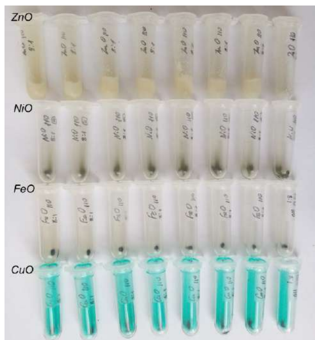
Рис. 5 – Зразки проб, відібрані з реакційної суміші для визначення концентрації олеїнової кислоти під час кінетичних досліджень її естерифікації бутан-1-олом у присутності оксидів металів
