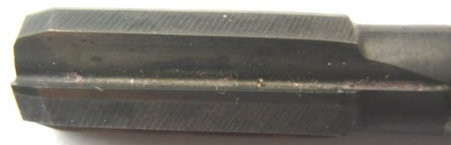
б – розвертка з цільного твердого сплаву VK6OM,
