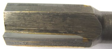
а – розвертка з твердосплавними пластинами VK6M, що дає змогу здійснювати підбір дна отвору,
