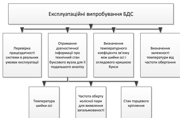
Рис. 2 – Схема програми експлуатаційних випробувань БДС
