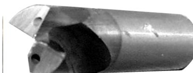
в – свердло з цільного твердого сплаву фірми «Hertel», застосоване для чистового розвірчування і підбирання дна отворів
