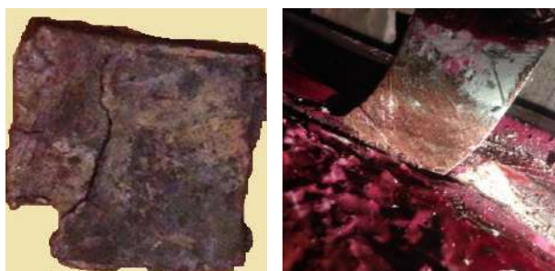
Рис. 3 – Ділянки міжполюсних перемичок, зруйнованих впливом температури (а) та динамічними навантаженнями (б)
