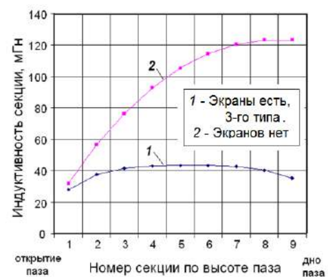
Рис. 15 – Результаты расчета индуктивности секций глубокопазной обмотки в зависимости от ее положения в пазу
