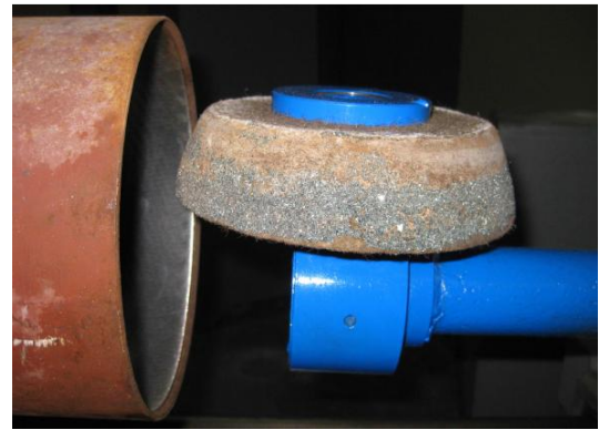
Рис. 2 – Схема внутреннего шлифования
