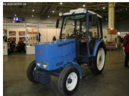
Рис. 5. XT3 Edison на базі шасі XT3 3512 та оснащений 24-кіловатними літій-іонними батареями
