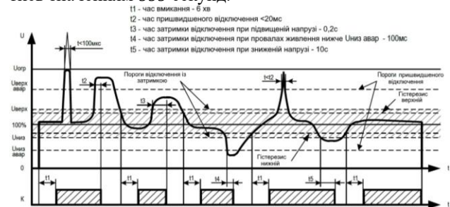
Рис. 5. Діаграма роботи реле з фіксованими параметрами
