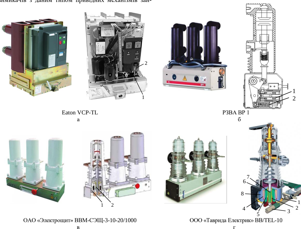
Рис. 3. Вакуумні вимикачі з моностабільними поляризованими електромагнітами та поворотними пружинами: 1 – моностабільний поляризований електромагніт; 2 – поворотна пружина; 3 – синхронізуючий вал; 4 – обмотка; 5 – якорь; 6 – статор; 7 – пружина підтискання; 8 – кільцевий постійний магніт; а, б – поворотна пружина встановлена окремо від електромагніту; в, г – поворотна пружина входить в конструкцію електромагніту
