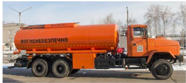
Рис. 1 – Паливозаправник КраЗ-63221 з цистерною АПЦ-20 валізної форми.
