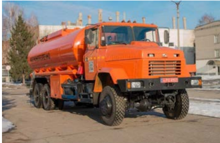
Рис. 1 – Паливозаправник КраЗ-63221 з цистерною АПЦ-20 валізної форми.
