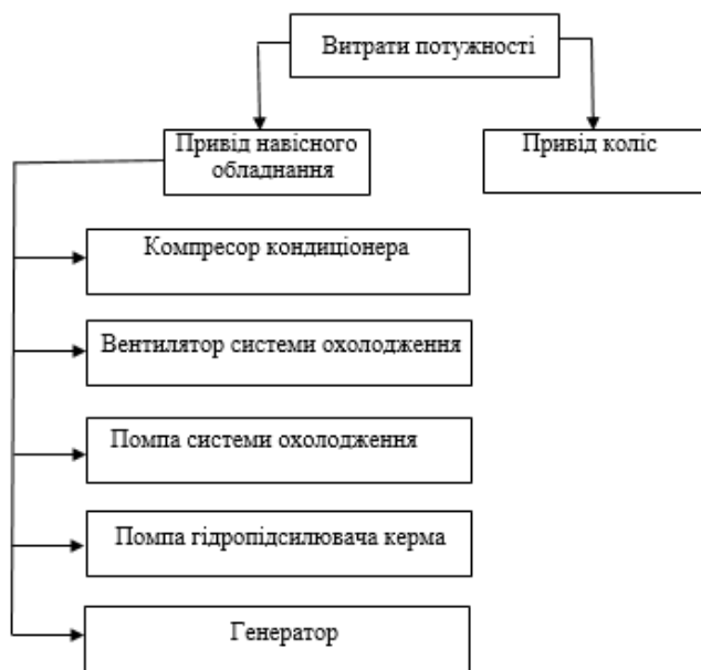
Рис. 1. Навісні споживачі потужності ДВЗ автомобіля
