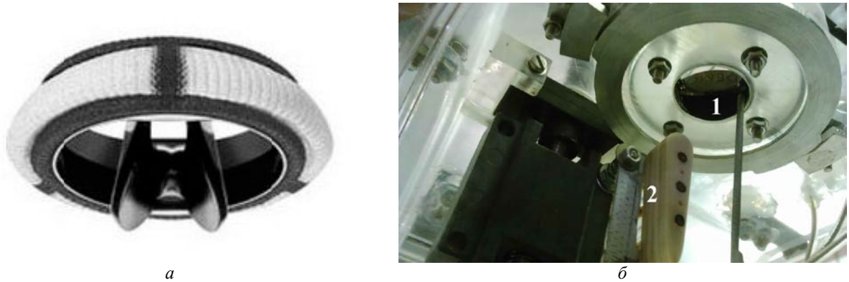
Рис. 1 – Двопелюстковий механічний клапан серця: a – відкритий; б – розташування над блоком датчиків.
