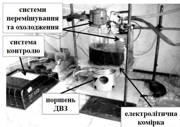
Рис. 1 – Установка для ПЕО-обробки поршня ДВЗ
