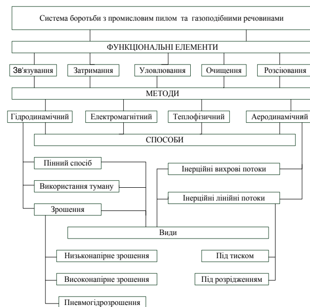
Рис. 1 – Класифікаційна схема боротьби з промисловим пилом і газоподібними викидами цементних заводів
