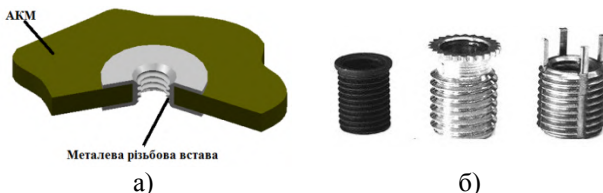
Рис. 1 – Реалізація різьбового з'єднання в армованому композиті за допомогою вставки:
