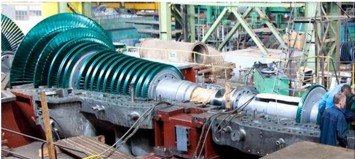
Рис. 14 – Комбинированный «композитный» ротор в цехе АО «Турбоатом»
