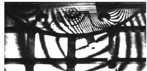
Рисунок 25 – Фрагмент спекл-інтерферограм переналагоджуваних лещат: сполучення підшва корпусу – базова плита
