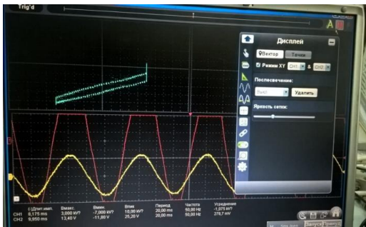
Рис. 8 – Трапецієдальна форма петлі діелектричного гістерезису зразка конденсатора з активним діелектриком
