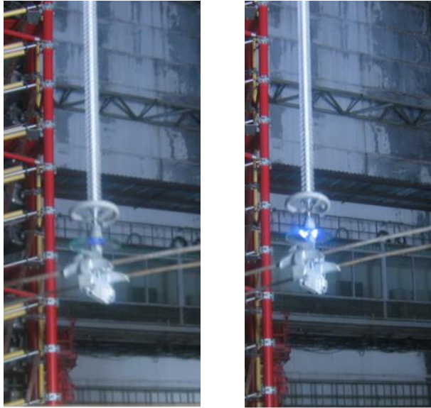
Рисунок 5 – Полимерный изолятор с электрическим повреждением длиной \Delta L : левое фото ЛК330+стандартный изолятор; правое фото ЛК330+индикатор, испытательное напряжение 205 \approx 210 кВ
