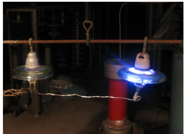
Рисунок 3 – Стандартный изолятор (слева) и разрядник-индикатор (справа), находящиеся под одним и тем же напряжением
