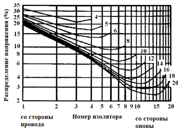
Рисунок 4 – Распределение напряжения от количества изоляторов составляющих гирлянду
