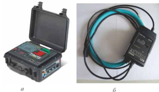
Рисунок 1 – Вимірювальний пристрій: а – портативний аналізатор якості електричної енергії; б – струмові роз'ємні кліщі
