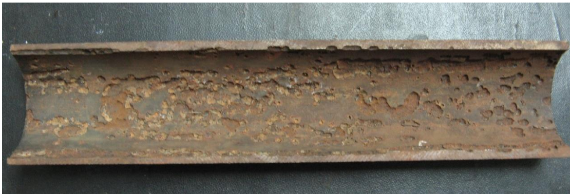
Рисунок 1 – Пошкодження на внутрішній поверхні газової труби (Харківська обл., Підприємство «Укргазвидобування»)
