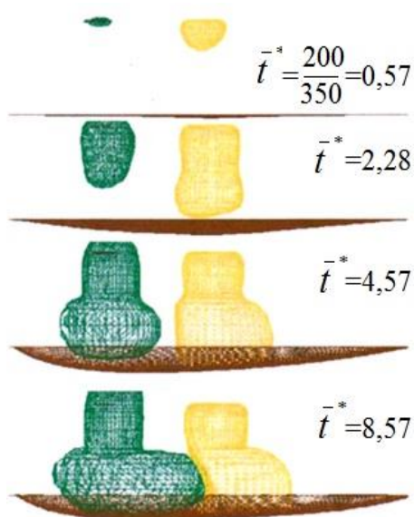
Рис. 2 – Последовательное изменение формы ППП и заготовки в моменты времени \bar{t}^* = 0,57; 2,28; 4,57; 8,57 (результаты моделирования). Точки на изображениях объектов свидетельствуют о проникновении сеток одного объекта моделирования в область другого объекта
