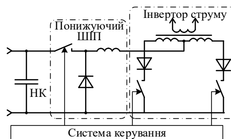
Рис. 3 Функціональна схема інверторної частини перетворювача
