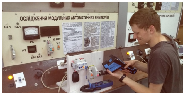
Рис. 26. Лабораторний стенд з дослідження LV брейкера побутового призначення розробив та виготовив дипломник-бакалаврант Денис Василенко (керівник - проф. Б.В. Клименко)
