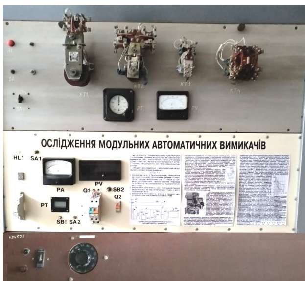
Рис. 1. Лабораторний стіл з двома стаціонарними стендами, розробленими у 70-і роки минулого століття (вгорі) та на початку 2000-х років (унизу) із застарілими й ненадійними комутаційними, захисними та сигнальними апаратами
