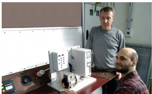
Рис. 15. Бакалаврський дипломний проект Володимира Пожидасва, виконаний під керівництвом доц. О.О. Чепелюка, був присвячений створенню мобільного лабораторного стенду з дослідження частотного регулятора швидкості обертання асинхронних двигунів, придбаного за кошти гранту.
