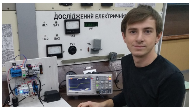
Рис. 27. Лабораторний стенд з дослідження можливостей двопроменевого цифрового осцилографа розробив та виготовив Максим Самокіш (керівник – ст. викл. С.В. Вировець)
