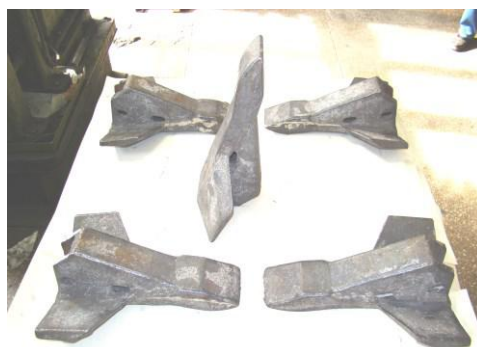
Рис. 4 – Лапы глубокого рыхления разрыхлителя «Soil Pro»
