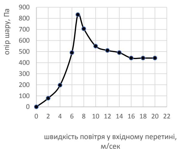
Рис. 4 – Залежність гідравлічного опору від швидкості теплоносія (кількість інертного носія 2 кг)
