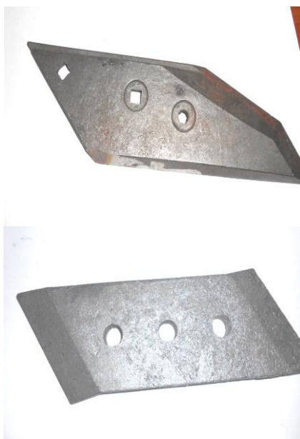
Рис. 3 – Насадки на лемеха фирм «Lemken»(а) и «Gregorie Besson»(б). Масса деталей – 2кг
