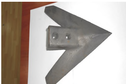
Рис. 2 – Литая лапа культиватора Great Plains. Масса детали - 2кг
