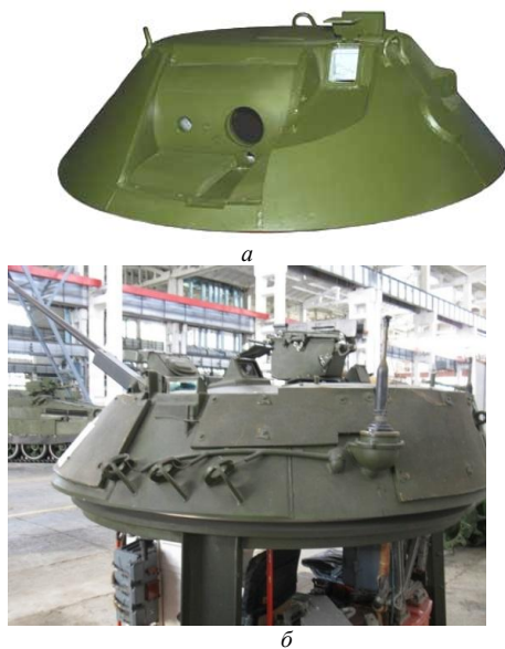
Рисунок 3 – Геометрія башт: а – БТР-80; б – БМП-2
