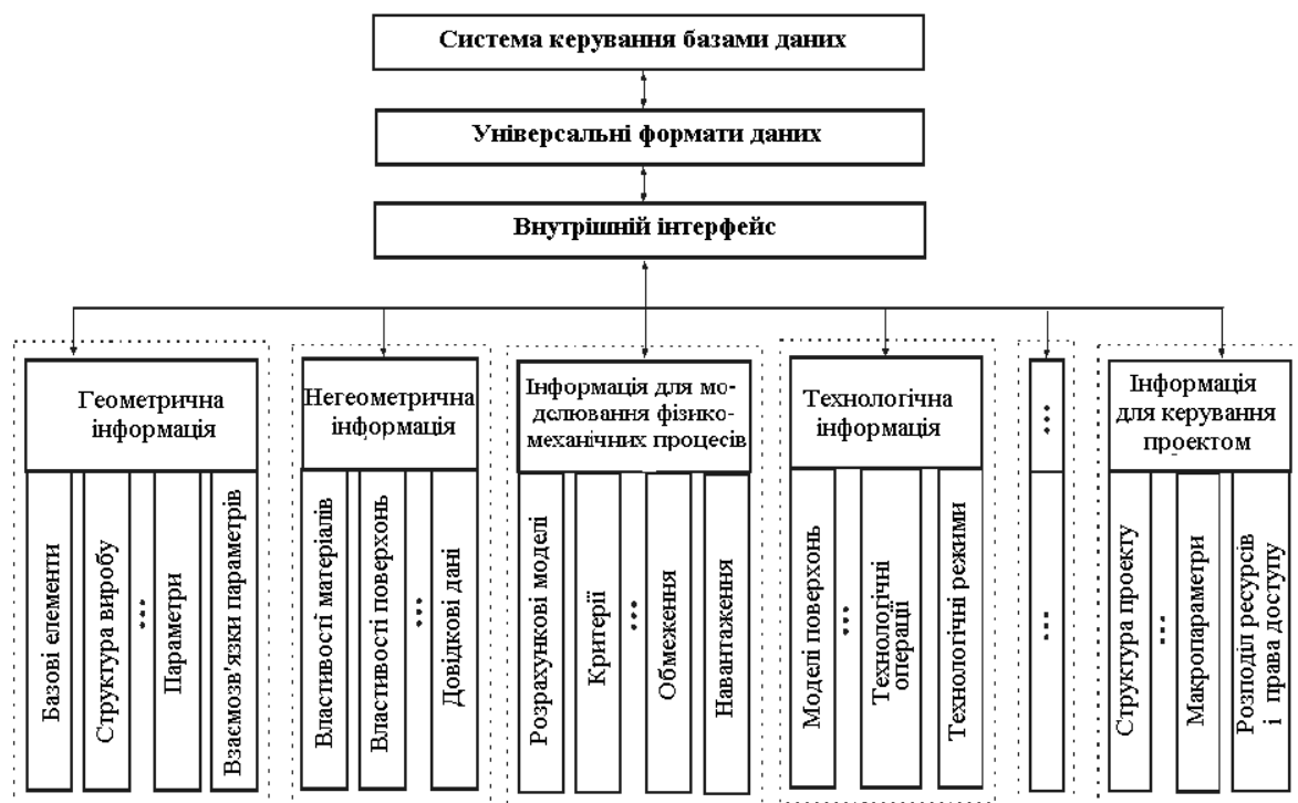
Рисунок 5 – Схема структури організації даних в інтегрованих системах автоматизованого проектування, дослідження та виготовлення
