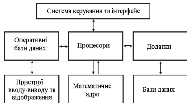
Рисунок 4 – Схема взаємодії елементів систем автоматизованого проектування, дослідження та виготовлення
