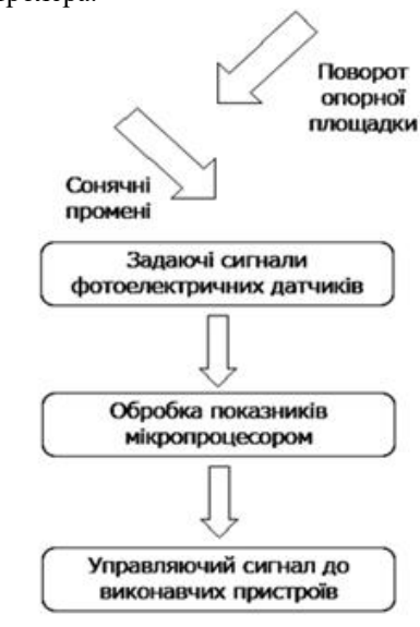
Рис.4 – Принцип роботи системи стеження, що базується на порівнянні показників фотоелектричних датчиків
