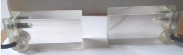
Рис. 3 – Электроакустические преобразователи с переменным углом ввода
