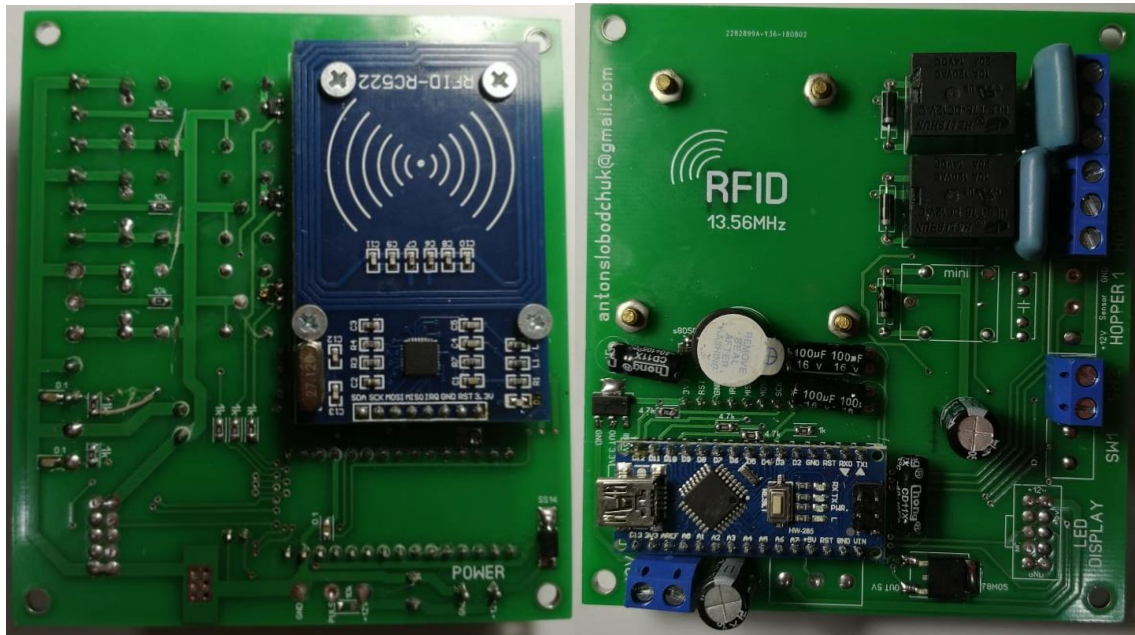
Рис. 5 – Діючий макет пристрою
