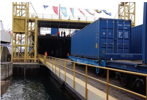
Рисунок 1 – Завантаження вагонів-платформ з контейнерами на залізничний пором
