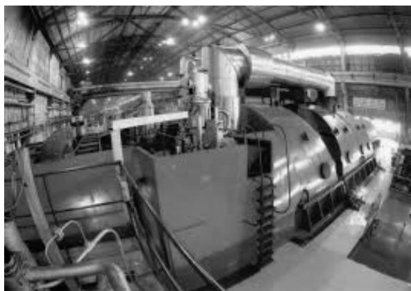
Рис. 1. Паровая турбина К-325-23,5 в машинном зале ТЭС «Аксу», Казахстан
