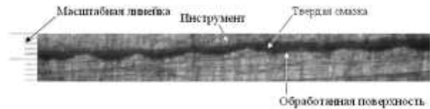
Рисунок 4 – Контакт инструмента с обрабатываемой поверхностью при использовании твердой смазки
