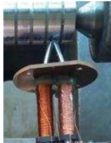
Рисунок 3 – Загальний вид інструменту – утворювачу обертового магнітного поля
