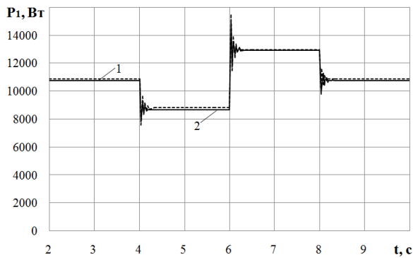
Рис. 3. Зависимости потребляемых активных мощностей: 1 – с базовым двигателем, 2 – с оптимизированным двигателем
