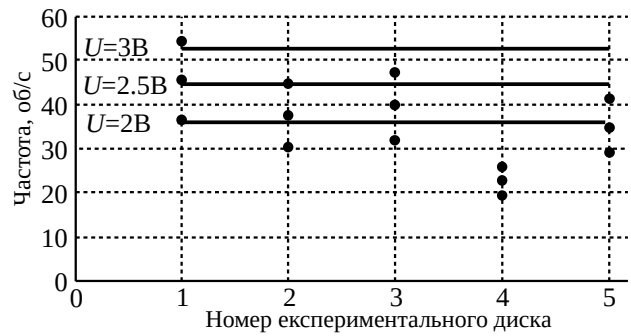
Рисунок 8 – Результати роботи енкодера без ідентифікації сигналу
