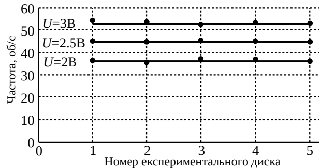
Рисунок 9 – Результати ідентифікації кутової швидкості енкодера
