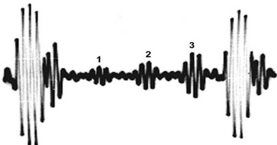
Рис. 2 – Додаткові імпульси (1, 2, 3) між двома донними сигналами, відбиті від «дна» виробу
