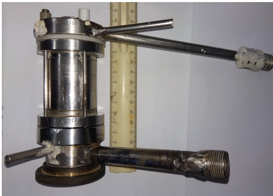
Рис. 2 – Частично модернизированный плазмотрон для широкого
